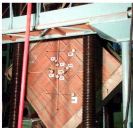
Рисунок 2.32 – Общий вид образца серии МС в испытательном прессе
