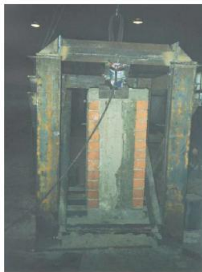
Рисунок 2.4 – Образец 4-х слойной стены на испытательном стенде
